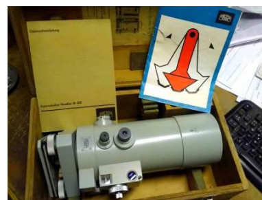
Nivelačný prístroj Ni 007 Zeiss, WEB Carl Zeiss Jena, 70. r. 20. stor.
